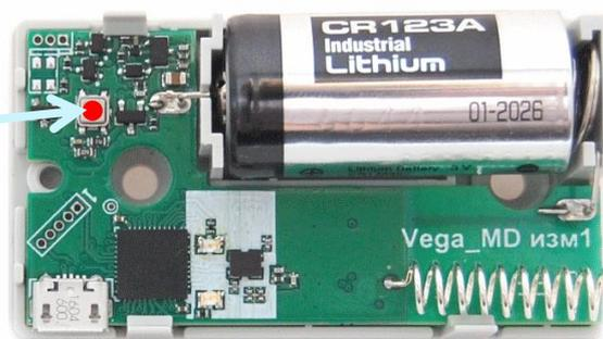
**2. Способ OTAA.** После нажатия на кнопку запуска, устройство осуществит три попытки присоединения к сети в заданном при настройке частотном плане. При получении подтверждения активации в сети LoRaWAN, устройство подаст сигнал индикатором (свечение в течение 5 секунд) и перейдет в режим «Активный». Если все попытки окажутся неудачными, датчик продолжит накопление данных и будет осуществлять попытки присоединения к сети раз в 6 часов.
